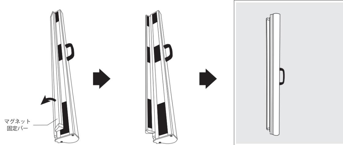
② 片手でハンドルを、もう片方の手でケースの下側を持ち、ハンドルが正面に見える方向に本体ケースを傾け、押さえローラー部分を黒板に押し付けながら下図の矢印の方向へスクリーンを引き出します。
